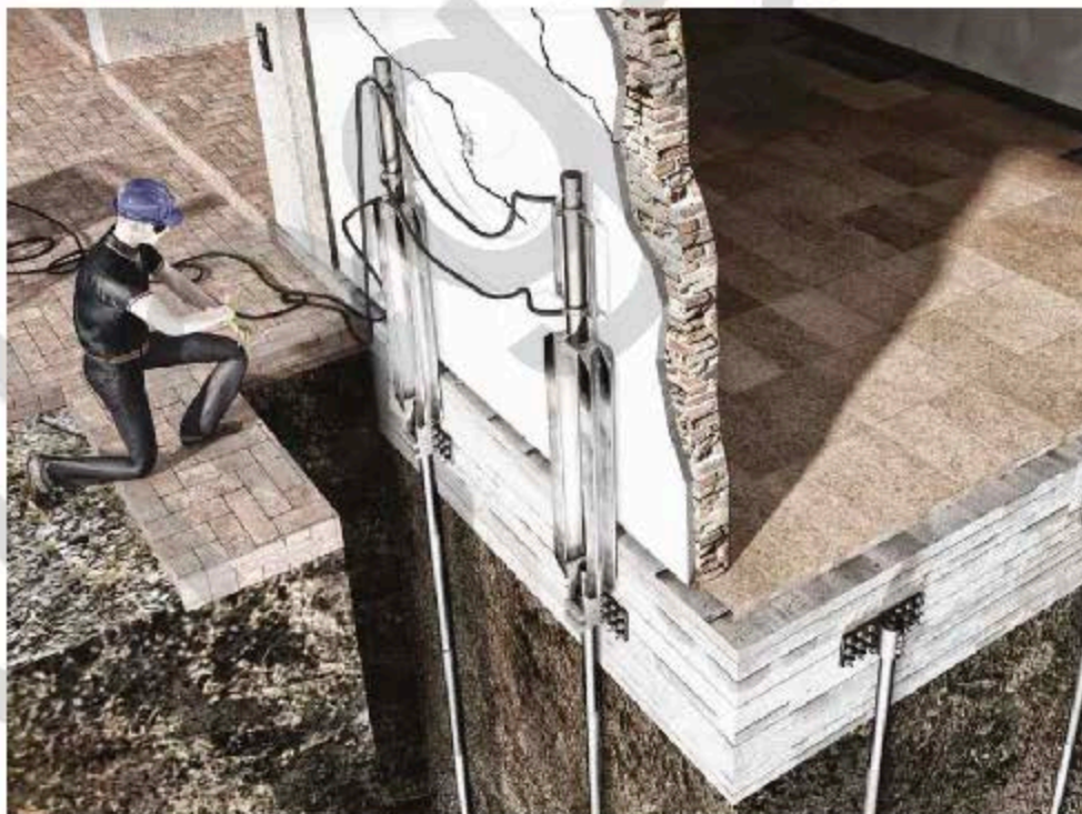
Figura 18 - Tecnica di consolidamento con palificazione attiva.
