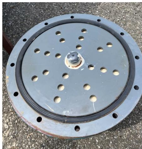
Dovranno essere realizzati il mantello (1) e la testata di fondo (2) mentre del filtro (3) andranno cambiate solo le guarnizioni in modo che non ci siano problemi di tenuta. Il mantello, diversamente dalle foto è possibile realizzarlo senza spie visive.
