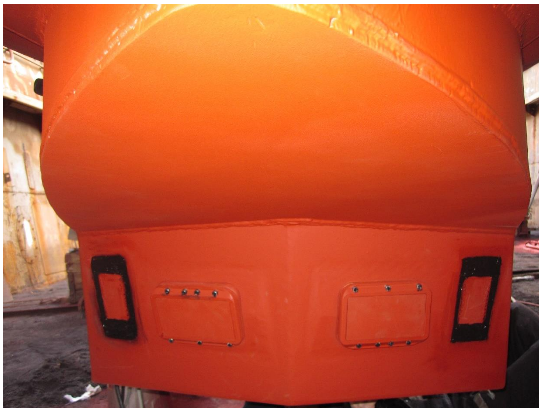
Figura 5 In posizione centrale i trasduttori del sistema ITI, ai due estremi gli idrofoni SCANMAR
