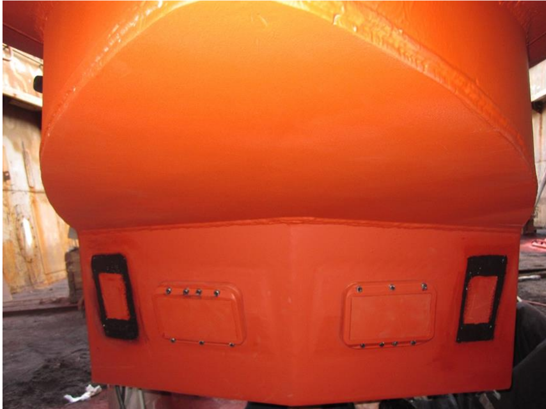
Figura 1. In posizione centrale i trasduttori del sistema ITI, ai due estremi gli idrofoni SCANMAR. Gli idrofoni SCANMAR sono collegati a due PI interface box per il loro utilizzo con ricevitore tipo SIMRAD SR70 visto che condividono lo stesso range di frequenza di esercizio.
