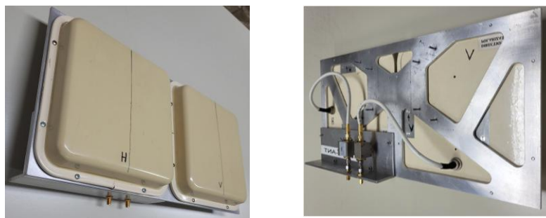
Figura 5: Coppia Antenne Banda L di antenne montate su frame meccanico: viste avanti e dietro
